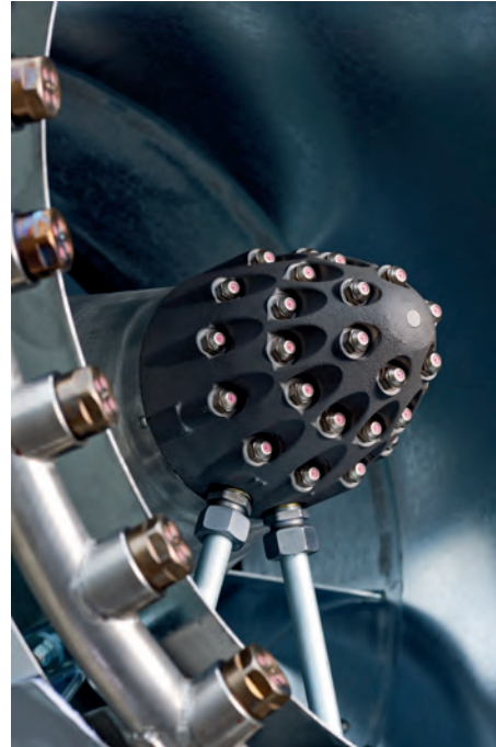
Деталь внешнего кольца и головки с форсунками типа TMP.
